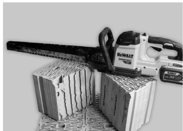
Durchsägen in den Führungsnuten
